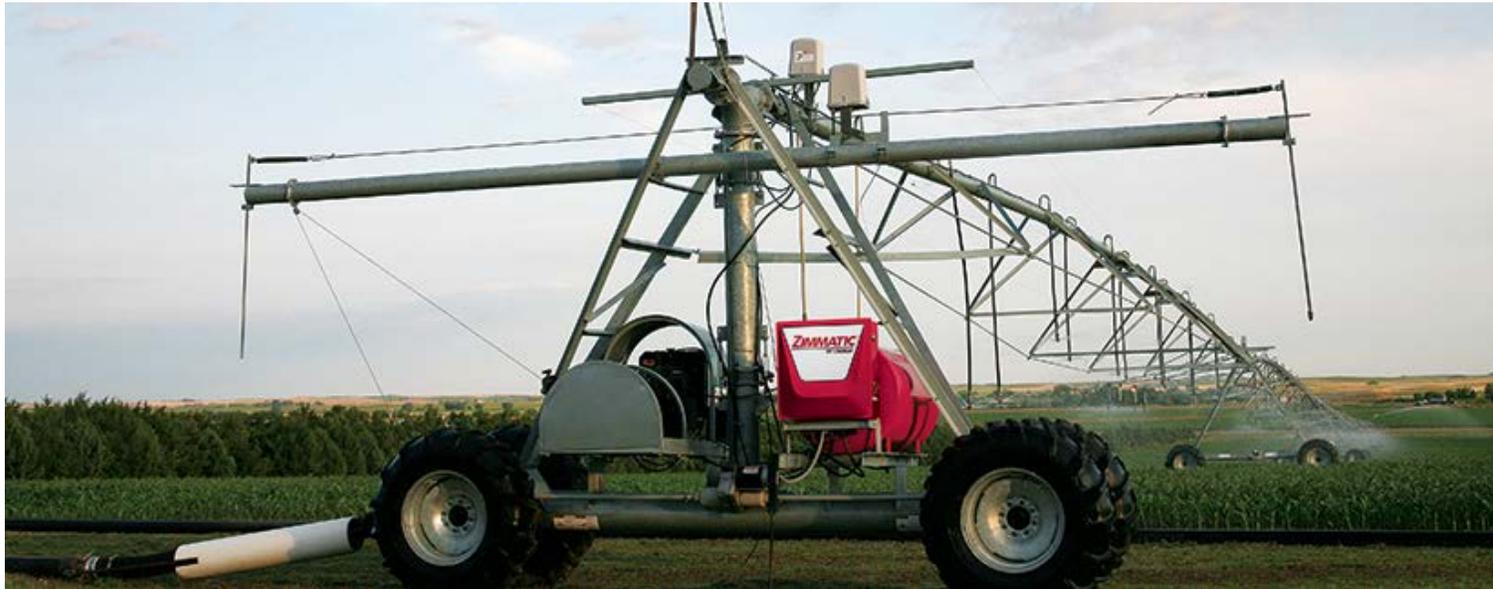
Sistema de irrigação por aspersão mecanizado tipo autopropelido.
